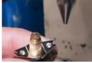
Fig. 32, Ribeteado de disco en motoprotector. Fuente: Elaboración
