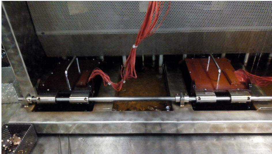
Fig. 13, Tinas de aceite para pruebas en maquina SDC. Fuente. Elaboración propia.
