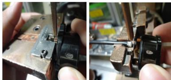
Fig. 36, Ensamble de cable a motoprotector. Fuente: Elaboración propia.
